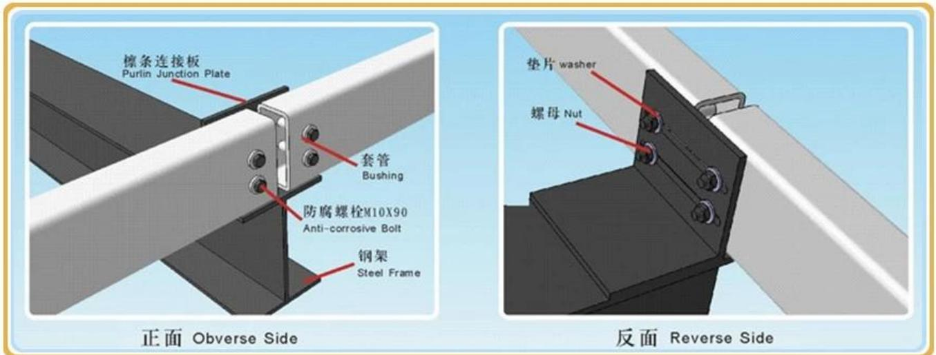
1. Bohren Sie die Pfette für die Montage der Buchsen
